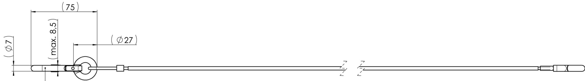
Prüfvorschrift nach **WN 9.830.04** (Prüfkraft Zugprüfung: 4,5kN)
