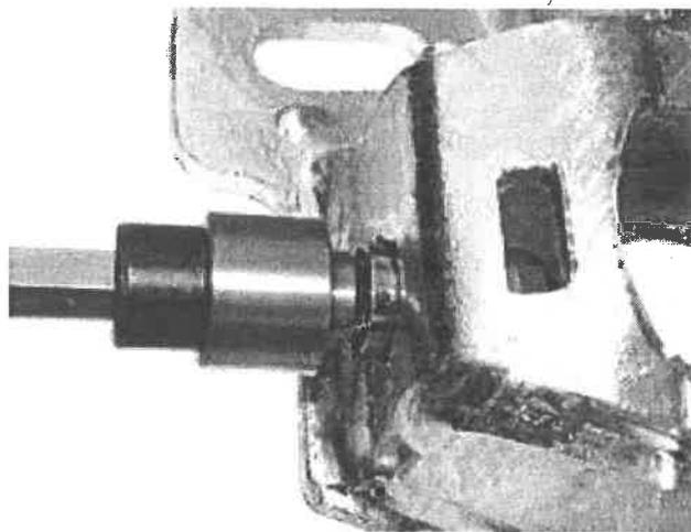
Nach der korrekten Montage sollte der Bund der Einnietmutter eine ähnliche Form, wie in der gezeigten Abbildung aufweisen.
