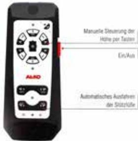
Manuelle Steuerung der Höhe per Tasten
