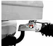
**Kupplungsgriff seitliche Bedienung, für Fahrzeuge mit niedriger Heckklappe**
